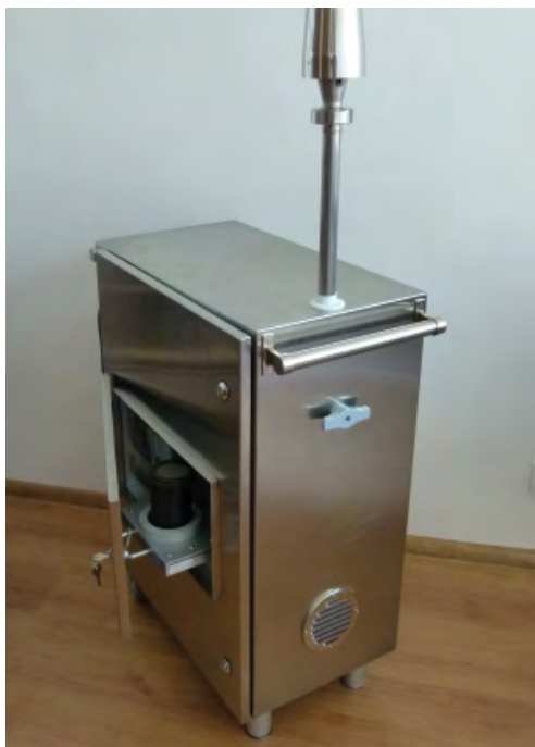
Przevoźna stacja do poboru jodu gazowego.
