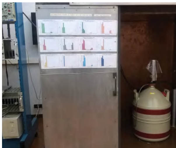
Detektor półprzewodnikowy HPGe do pomiarów gamma-spektrometrycznych próbek środowiskowych.
