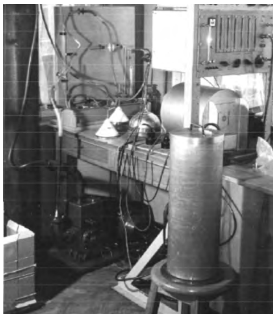
Aparatura do pomiaru stężenia radonu ^{222}\text{Rn} w powietrzu.
