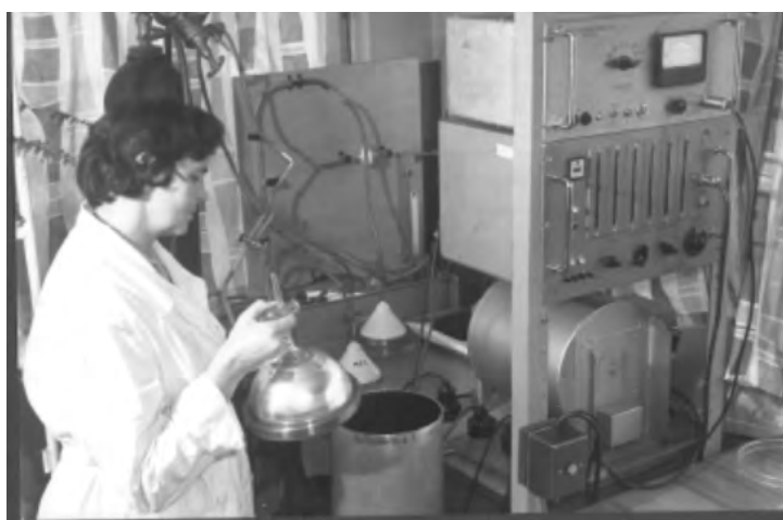
Urządzenie do oznaczania małych stężeń ^{222}\text{Rn} .
