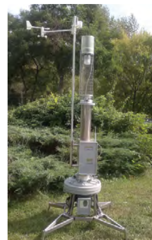
Przewoźna stacja MAS-1000 do poboru aerozoli.
