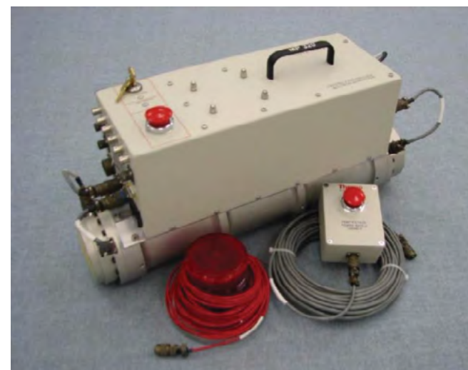
Generator neutronów typu D-T.
