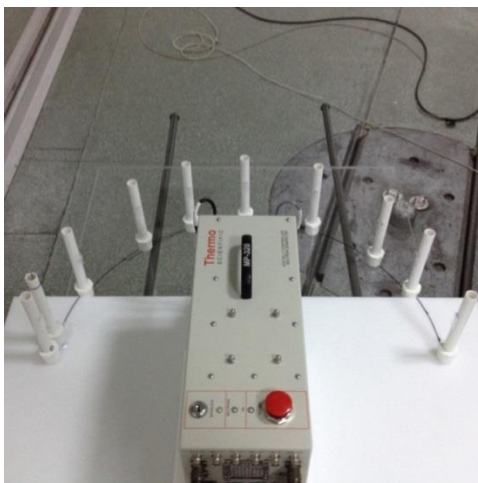
Rysunek 2. Rozmieszczenie detektorów śladowych CR-39 w płaszczyźnie wertykalnej w otoczeniu generatora.
